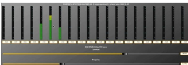
Cet analyseur de spectre, basique, fabriqué à l'aide d'une banque de filtres à Q constant, est conforme à la nature de l'audition. La résolution en fréquence de l'audition est à Q constant en première approximation sur la plus grande partie du spectre. Des échelles de fréquence auditives plus précises existent comme les Mel, les Bark et Equivalent Rectangular Bandwidth (ERB).
