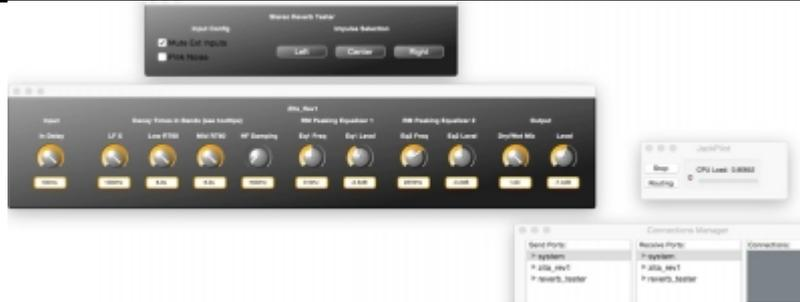
Nous avons un testeur de réverbération stéréo qui émet une impulsion dans les canaux du milieu, de gauche ou de droite. On peut également écouter le son produit par des microphones externes. On peut également alimenter le système avec un bruit rose.
