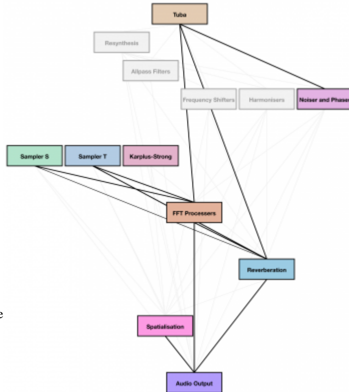
Figure 7. Représentation TaCEM du graphe de synthèse et de traitement de signal pour Music for Tuba
